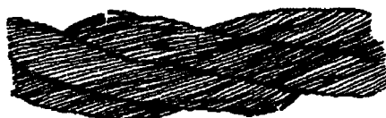
Рисунок 1. Обрывы и смещения проволок каната крестовой свивки
