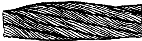
Рисунок 13. Местное увеличение диаметра каната
