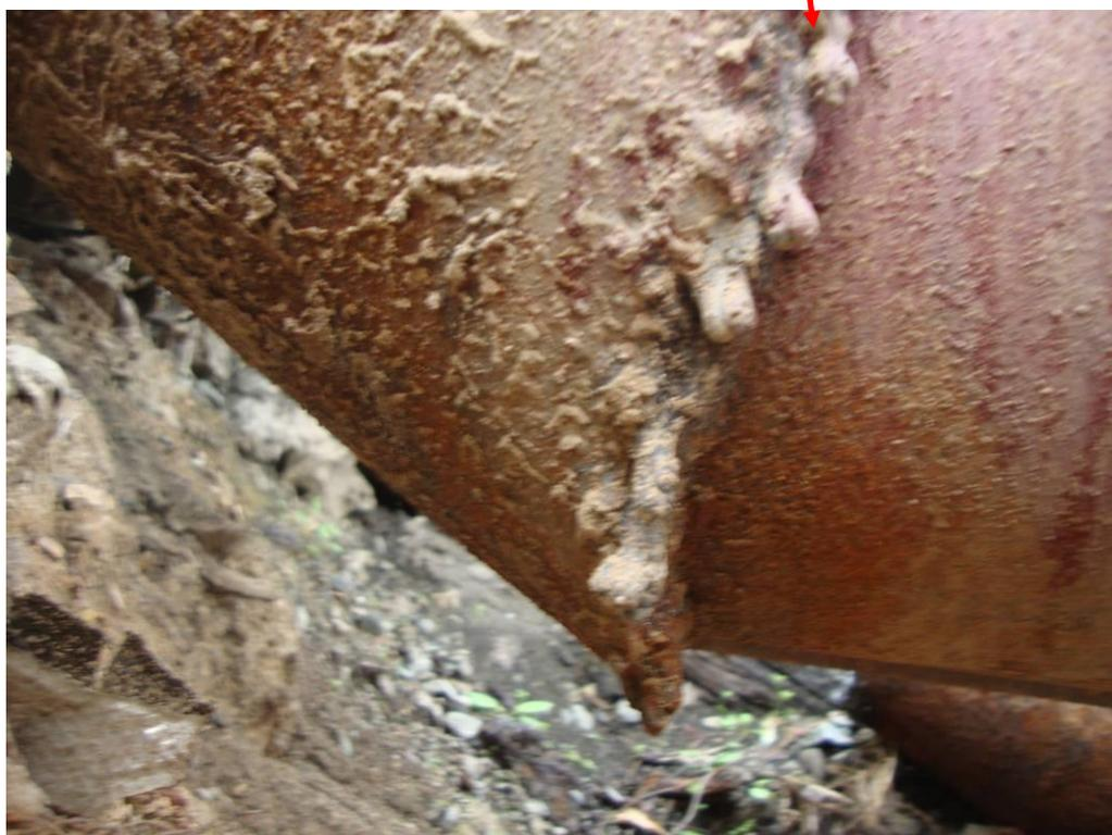
**Сварное соединение отвода**
