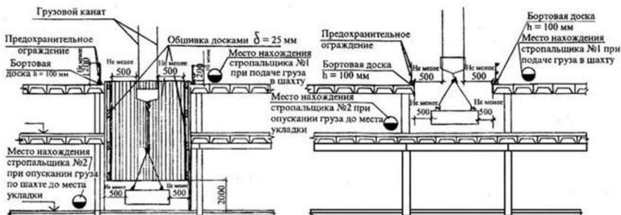
Рисунок 28 – Подача грузов в проемы перекрытий
