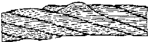
в) выдавливание проволок в одной пряди
