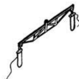
Траверса универсальная для подъема ферм, балок
