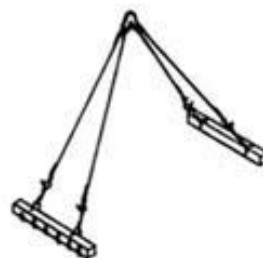
Траверса для подъема карт из профнастила
