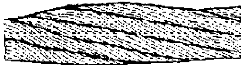
д) местное увеличение диаметра каната
