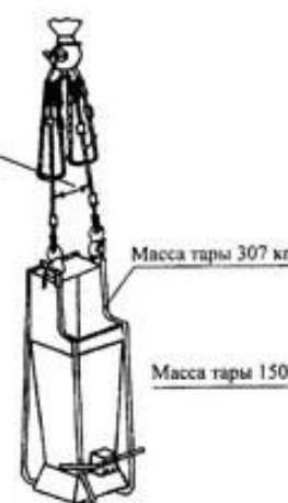
Строп 4СК1-10,0 Q=10,0 тс при подаче бункера(балды) с бетонной смесью V=1 м 3 Р=3,0 т
