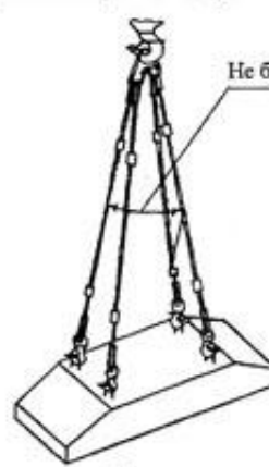
Строп 4СК1-3,2; 4СК1-5,0; 4СК1-10,0 Q=3,2+10,0 тс при монтаже фундаментных блоков P=0,88+7,32 т
