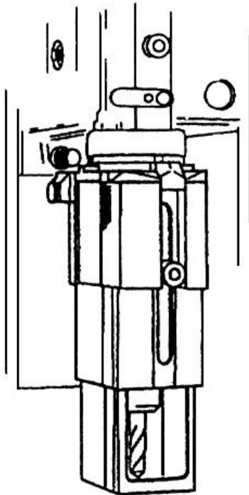
Рисунок 5 - Регулируемое съемное защитное устройство
