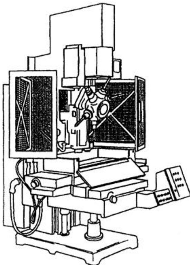
Рисунок 6 - Пример съемных защитных устройств, блокируемых откидными ограждениями
