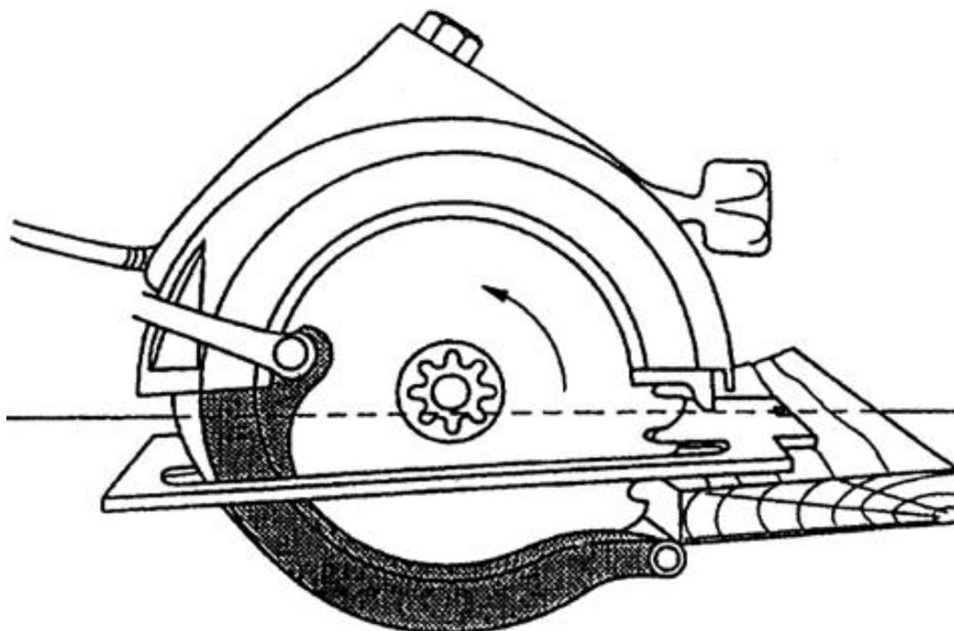
Рисунок 4 - Пример автоматически запирающегося съемного защитного устройства
