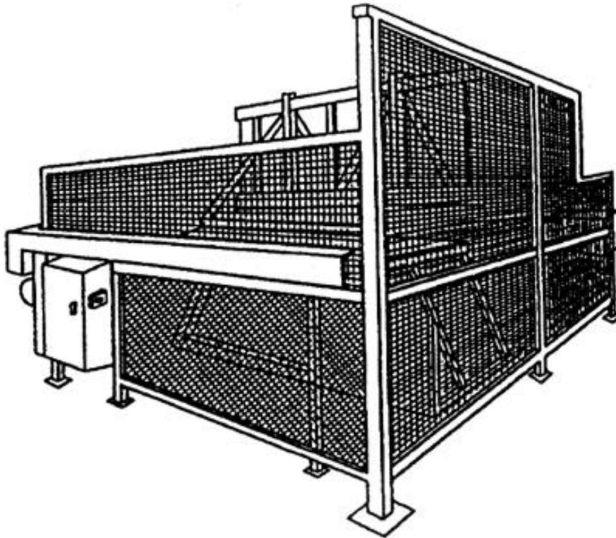
Рисунок 2 - Пример съемного дистанционного защитного устройства
