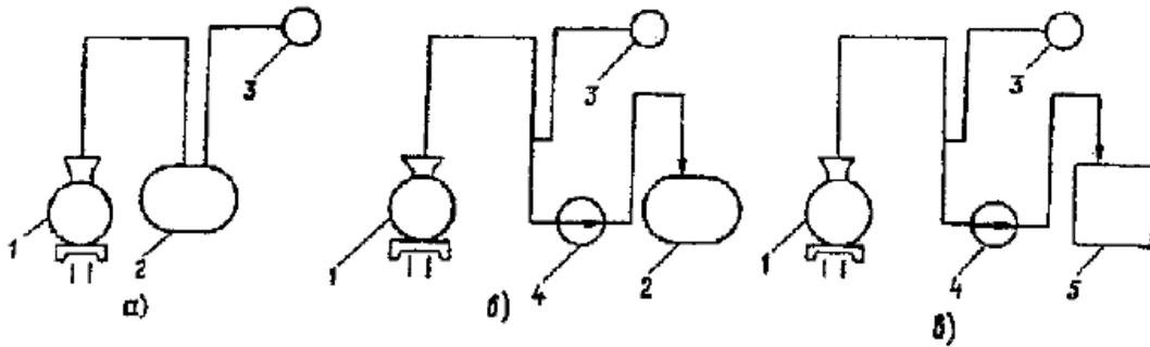
Рис. 1. Схемы (а, б, в) разгрузки железнодорожных цистерн:
