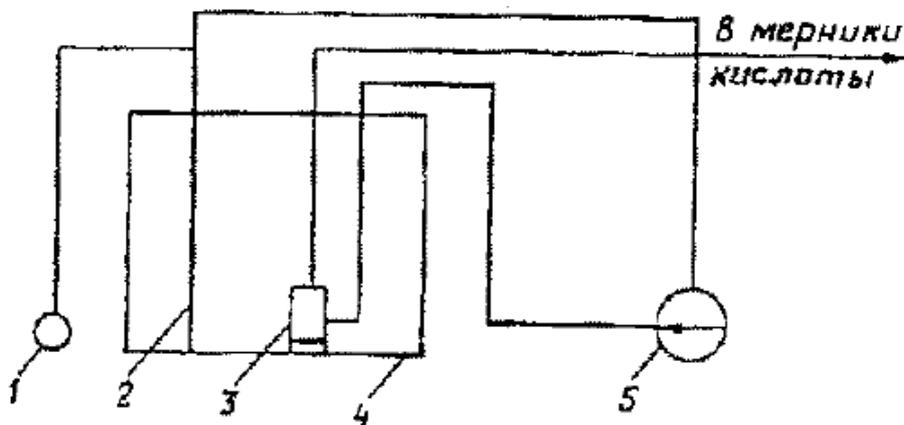
Рис. 5. Схема эжекторной установки:
