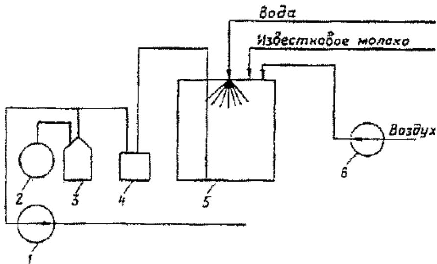
Рис. 4. Схема промывки емкостей хранения серной кислоты:
